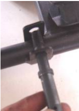
Figure 3 – Mise en place de l'axe
