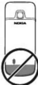
Il dispositivo potrebbe essere dotato antenne interne ed esterne. Evitare di toccare l'antenna mentre questa sta trasmettendo o ricevendo, se non è strettamente necessario. Il contatto con le antenne ha impatto sulla qualità delle comunicazioni radio e può comportare un maggiore consumo energetico durante l'utilizzo del dispositivo nonché una riduzione della durata della batteria.
