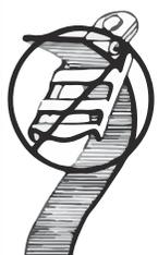
2. MAKE SURE THAT TOP BUCKLES ARE THREADED AS SHOWN ON LEFT, NOT AS ON RIGHT.
